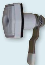
Pour épaisseur de portillon 37 mm maxi. Montage avec barillet Zadi / sTs. Livrée avec joint de montage, came coudée X815406 et écrou, rondelles d'épaisseur; sans barillet
