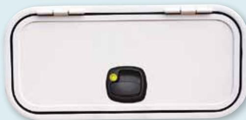
Cadre laqué blanc RAL 9010 avec panneau sandwich en tôle lisse coloris blanc RAL 9010, isolant Styrofoam et revêtement intérieur en ABS coloris RAL 9002.
