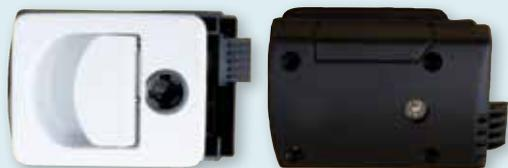
Encastrables avec poignée ergonomique. Pour épaisseur de portillon de 24 à 35 mm, entraxe 73 x 53 mm. Montage avec barillet Zadi / sTs.
