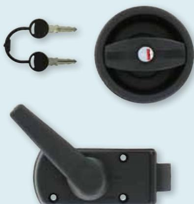
Livrée avec barillet + 2 clés. Dimensions : poignée Ø 110 mm (encastrement Ø 92 mm), partie intérieure 120 x 56 mm, entraxe 65 x 37 mm. Montage sur portes d'épaisseur 35 mm
