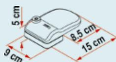
Serrure extérieure de sécurité pour porte ou portillon, d'une installation simple grâce aux vis auto-taraudeuses fournies. Se fixe sur la paroi du véhicule (vissage sur contreplaque intérieure). Coloris blanc
