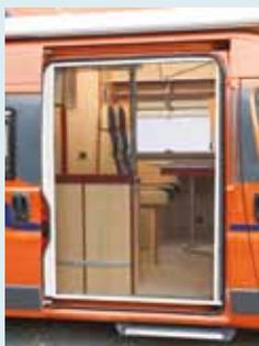
Moustiquaire spécialement conçue pour la porte latérale des fourgons aménagés. S'adapte parfaitement aux emplacements de montage et ne gêne pas l'ouverture de la porte. Cadre en aluminium laqué gris anthracite, épaisseur 26 mm. Avant de commander, vérifiez que l'aménagement intérieur du véhicule ne gêne pas le montage. Nous tenons à votre disposition la notice de montage pour vérifier la compatibilité du véhicule.
