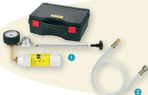
Permet de mettre l'installation gaz sous pression pour vérification de l'étanchéité (selon norme EN 1949). Contient 1 limiteur de pression (150 mBar), un manomètre à aiguille (0-250 mBar - 2.5 Bar maxi), un récipient capacité 600 cm<sup>3</sup> (pour les véhicules dont le circuit est inférieur à 700 cm<sup>3</sup>). Livré dans sa mallette de transport
