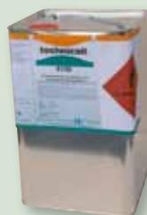
Pour matériaux d'isolations, tissus, métal, aluminium, fibres plastiques et fibres de verre, polystyrène etc... Prêt à l'emploi (pas besoin de diluant ni de durcisseur). S'applique au pistolet (avec une buse de 2,5 mm) sur les 2 parties à coller. Temps de séchage 15 minutes environ. Température d'application 15~25 °C.
