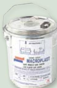
Colle polyuréthane bi-composante sans solvant, thixotrope adaptée pour le collage de supports verticaux sans risque de coulure de la colle avant assemblage, et apportant de très bonnes résistances sur de nombreux supports industriels dont les panneaux sandwichs. Bidon en 2 compartiments avec durcisseur intégré (à mélanger au moment de l'utilisation). S'applique à la spatule.
