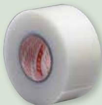
Ruban adhésif simple face développé pour les applications d'étanchéité difficiles et qui offre une très bonne durabilité dans des conditions extérieures. Permet la réalisation de l'étanchéité d'un joint existant, d'un cordon de soudure ou d'un rivet, même en extérieur, en première monte ou en réparation. Auto-amalgamant, il se recolle sur lui même. Peut être peint, ne jaunit pas, ne craquèle pas sous UV. Reste souple pour absorber les vibrations, les déformations et les dilatations de surfaces.
