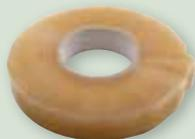
Base caoutchouc synthétique et résine sans solvant utilisé pour la jonction des panneaux latéraux de tôles avec pli (type Européen / Pittsburg). Fort pouvoir adhésif, ne durcit pas, permet un assemblage étanche. Dimensions 19 x 1 mm.
